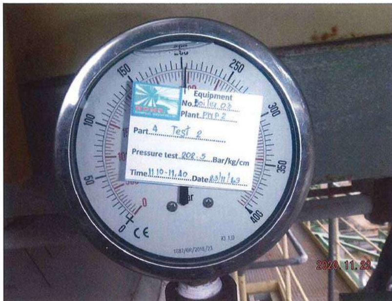
ภาพแสดงแรงดันขณะทำการทดสอบแรงดัน
